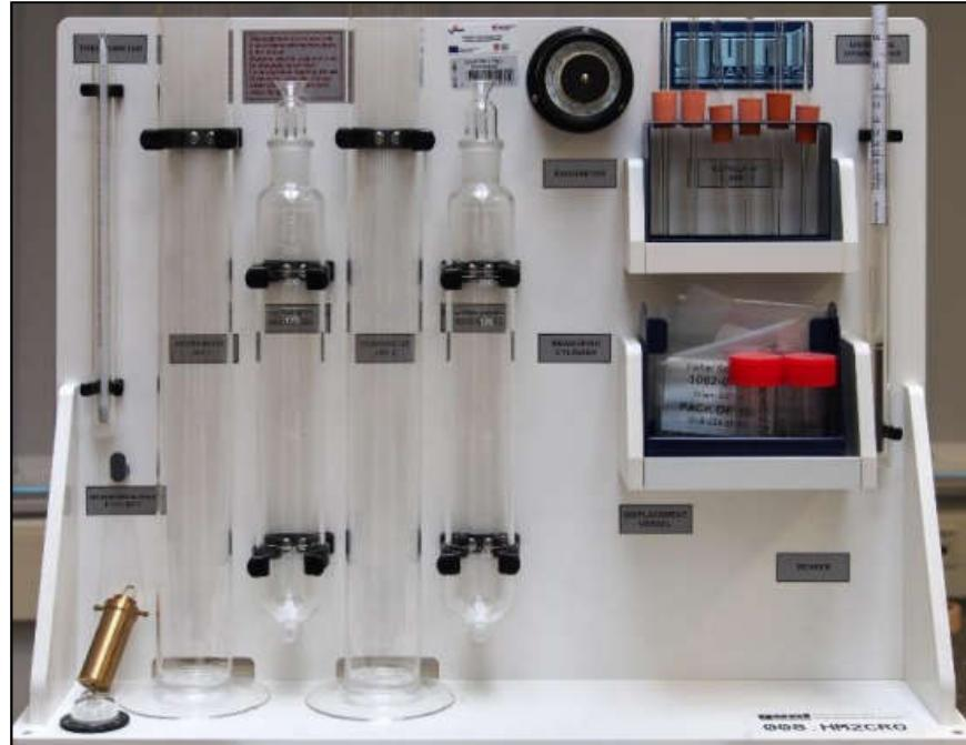
**Kratki opis opreme:** Uredaj za mjerjenje osnovnih mehaničkih karakteristika fluida.
