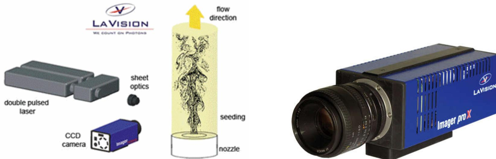
Digitalna kamera i PIV tehnologija (programski paket omogućava izračun brzina i smjer kretanja fluida)
