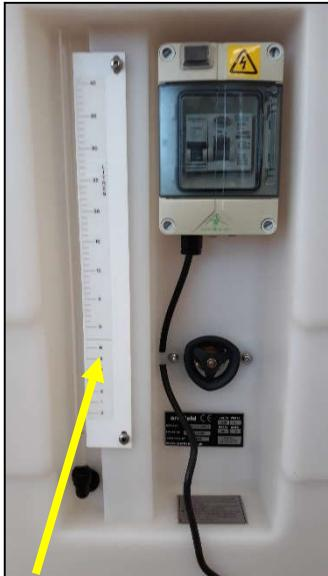
Volumetrijsko mjerjenje protoka
